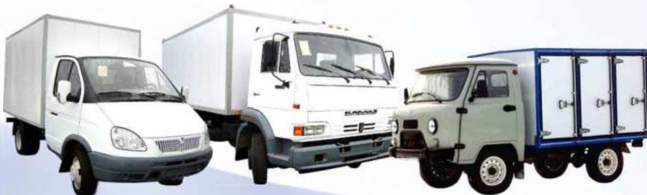
Автомобили специальные грузовые с изотермическим кузовом на базе шасси ГАЗ и КАМАЗ
